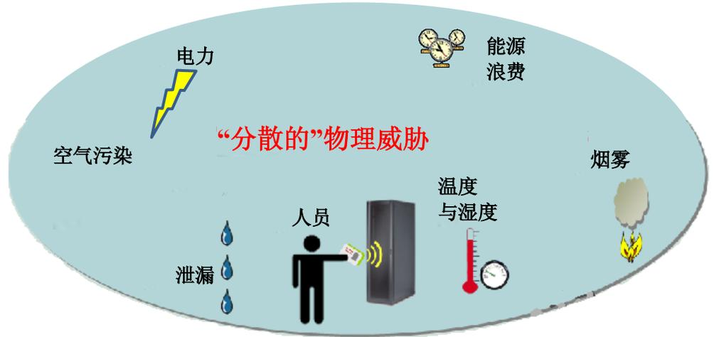
在下文中列出的意外事件将说明缺少简单易用的监测和自动化系统可能会导致网络配线间和服务器机房宕机。在这些环境中，并无工作人员值守，或者现场的工作人员无法向系统管理员发送故障信息。提前一小时发现制冷故障对于全面避免停电故障关系重大。快速、实时的警报使管理员能够监控所发生的变化，以避免服务中断。
